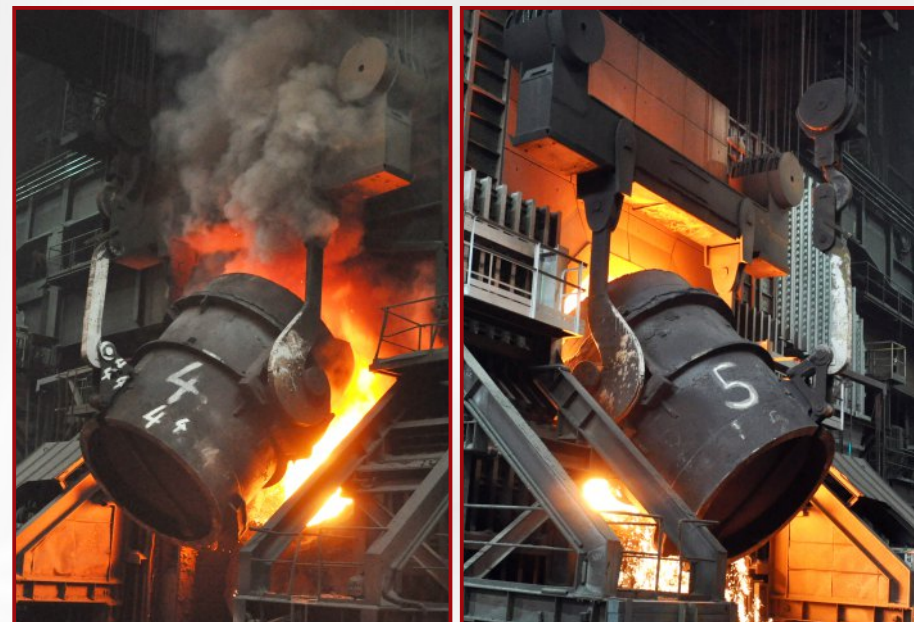
Srovnání emisí před a po instalaci sekundárního odprášení haly KKO
