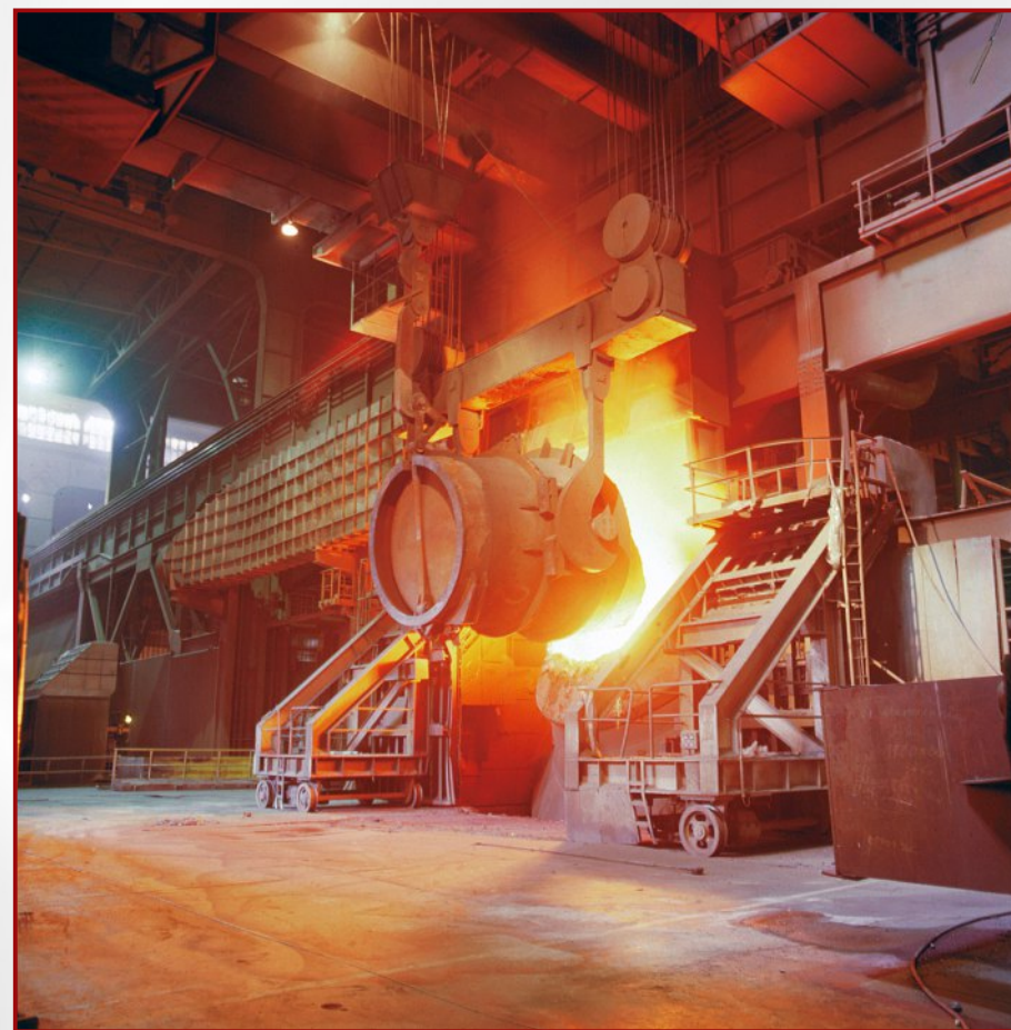
Vsázka surového železa do konvertoru 80. léta 20. století
