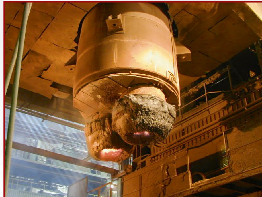
Vakuovací zařízení typu RH
