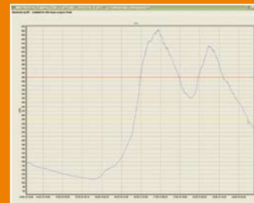
MONITORING VÝŠKY HLADINY ŘEKY OLŠE OD 14.5. DO 19.5.2010 MONITORING OF THE OLŠE RIVER LEVEL BETWEEN 14TH AND 19TH MAY
