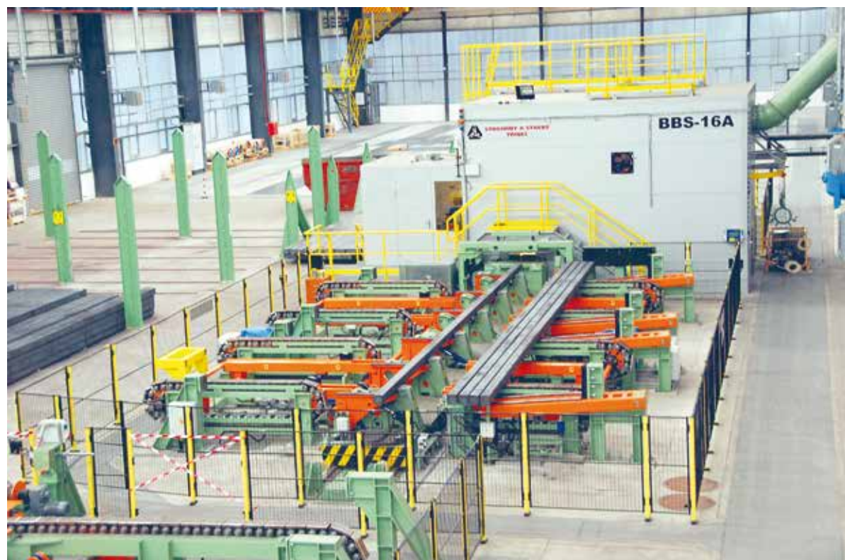
Mezi významné zakázky pro Třinecké železářny patřila dodávka nového vlastního výrobku - brusky BBS 16 pro novou čistírnu sochorů. Foto: archiv SaS.
