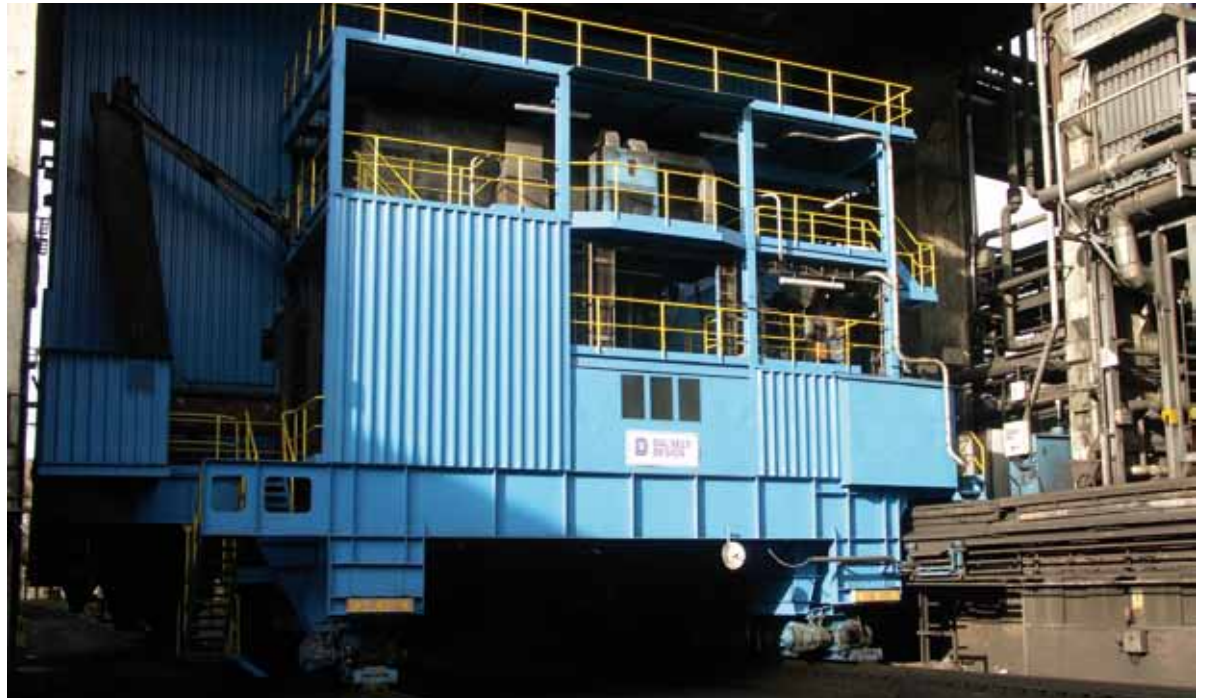
Výtlačný a pěchovací stroj č. 5 po rekonstrukci pod uhelnou věží při nabírání uhlí.
